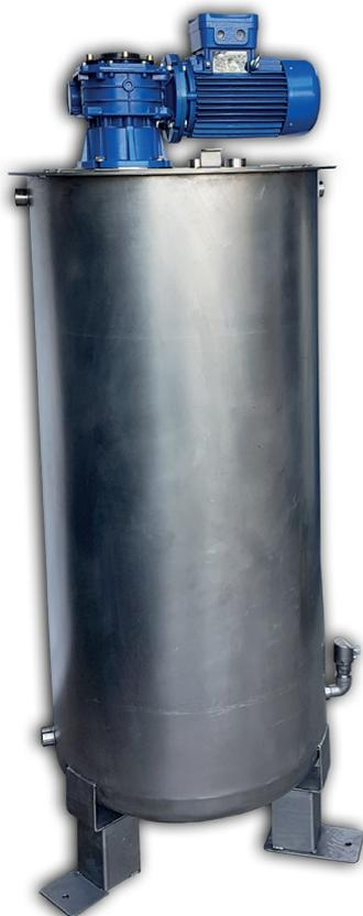
Stazione di accumulo con serbatoio inox a finitura satinata e fondo bombato anti-sedimenti. L'agitatore integrato consente l'omogenizzazione di tutto il contenuto fluido con una pala specializzata assiale-radiale. Il dispositivo di rilevamento livello integrato permette la gestione percentuale dei fluidi in arrivo per il "blending" da preparare e successivamente da dispensare al processo.
