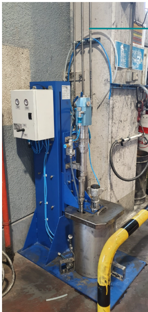
Dettaglio gruppo filtro integrato a regolatore di pressione Airmation e pistola manuale di atomizzazione con extension
