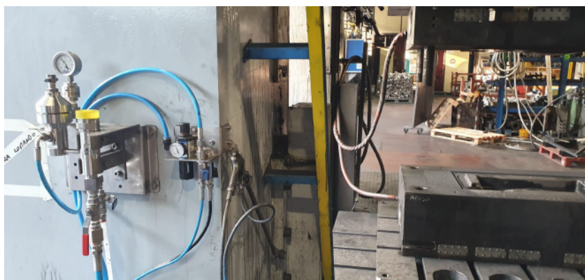
Dettaglio gruppo filtro integrato a regolatore di pressione Airmation e pistola manuale di atomizzazione con extension
